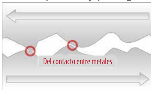
Figura 1: asperezas en superficies metálicas que rozan entre sí
