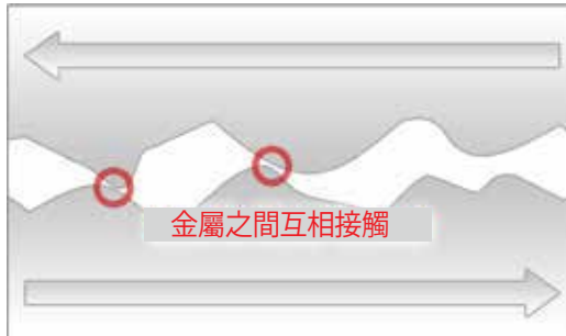
圖 1：金屬接觸表面的粗糙度
