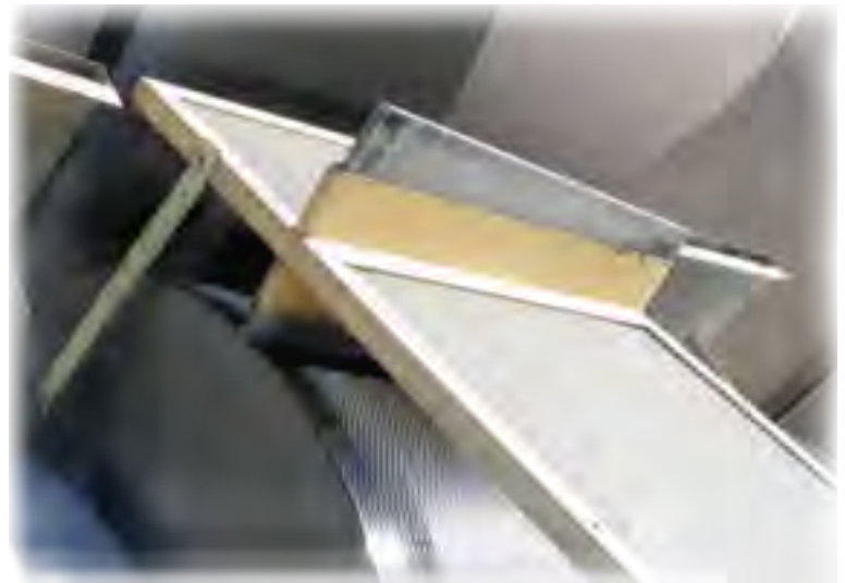
Bei Zapfenrollen liegt der Block in einem Halter gegen die rotierende Oberfläche und nutzt die Schwerkraft, um das Gewicht des Blocks auf die lasttragende Oberfläche zu übertragen. Dies maximiert die Übertragung des Graphits auf die lasttragende Oberfläche, minimiert den Verschleiß von Rollen und Reifen und gewährleistet optimale Leistung bei allen Drücken und Temperaturen.
