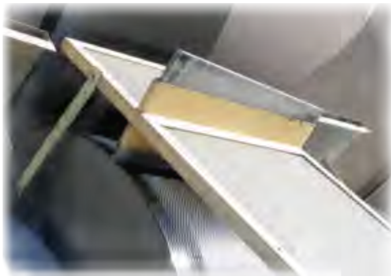
在耳軸滾輪上，石墨塊安裝在支架中，靠著旋轉表面運行，利用重力將石墨塊的重量轉移到承重表面上。這種設計最大化了石墨與承重表面的接觸，將滾輪和輪胎的磨損降至最小，並確保在各種壓力和溫度下的最佳性能。
