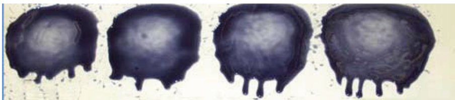
Diagrama de Spray luego de convertir a Pyroshield Syn Open Gear. Las boquillas de rociado no son obstruidas por el fluido lubricante Pyroshield, permitiendo una uniforme película de lubricante brindando mayor protección a los engranajes.
