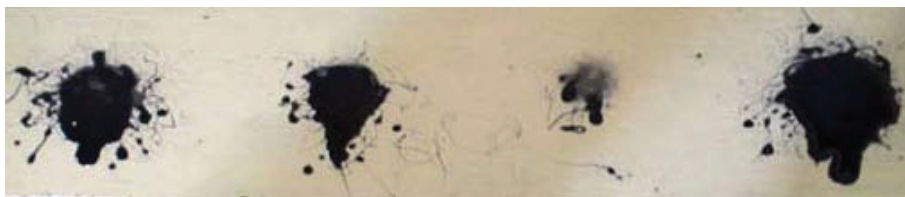
Diagrama de Spray de los lubricantes de grado comercial. Los tradicionales lubricantes asfálticos provocan obstrucciones en las boquillas de rociado dando lugar a una pobre aplicación de lubricante y la creación de dañinas manchas calientes en los engranajes.
